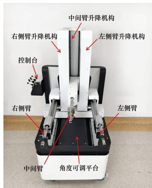
图 1 三臂十一轴骨折复位机器人结构示意图
