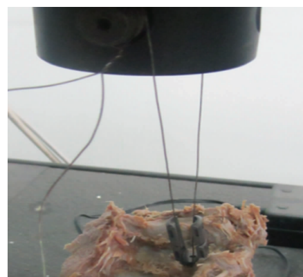
图 2 螺钉抗拔出力测定
