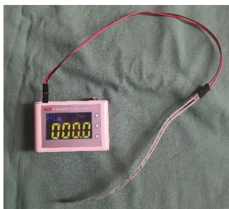
图 2 微型薄膜压力测试仪和薄膜压力传感器
