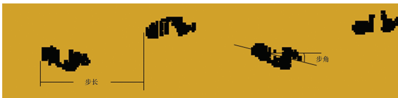
图 2 步长和步角测量方法示意图
