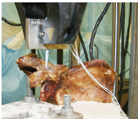
图 2 肩关节脱位喙锁韧带重建后力学测试实验
